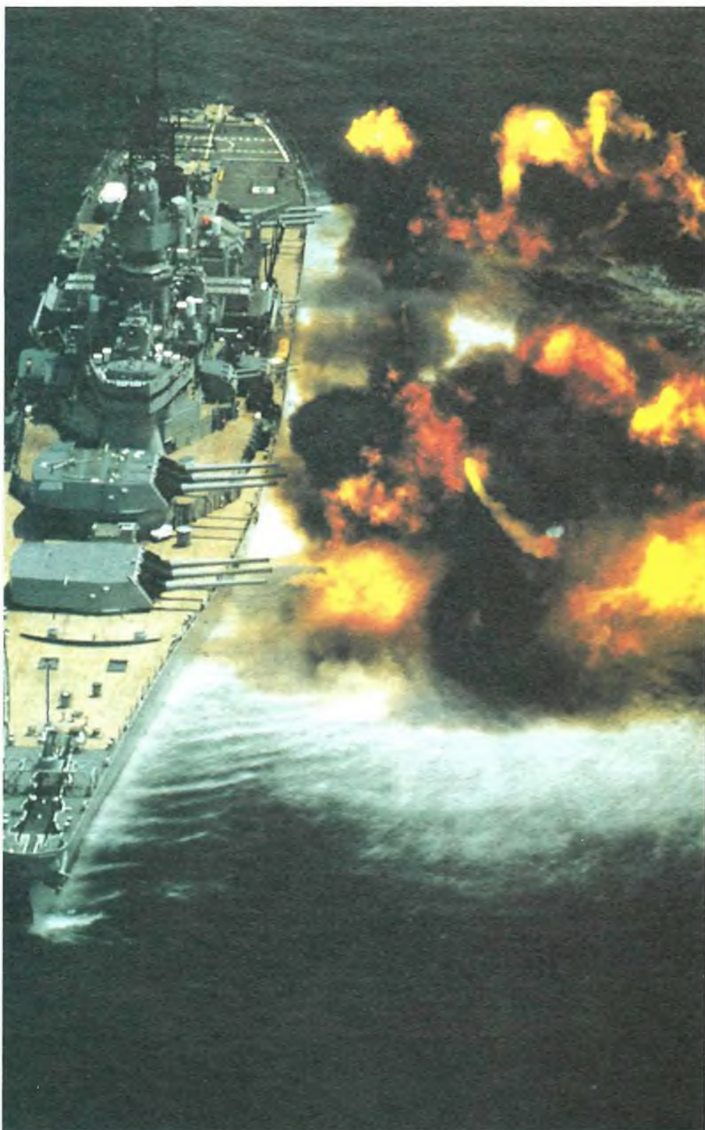
Линкор "Iowa" (США). В 1943–44 годах был построен целый класс таких кораблей. Они оказались настолько хороши, что были сняты с вооружения только совсем недавно. Несмотря на многочисленные модернизации, "Iowa" сохранил свое первоначальное вооружение — девять 16" орудий с дальностью стрельбы до 73 км (при использовании современных активно-реактивных снарядов)
